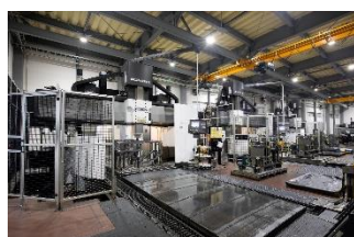
06 機械加工(仕上げ加工) 大型五面加工機を13台保有し、大型の筐体も精密な機械加工が可能
