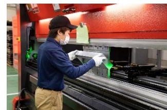
04 曲げ加工 ロボットによる全自動ペンディングマシン、自動金型ペンディングマシンにて安全で効率的な曲げ加工
