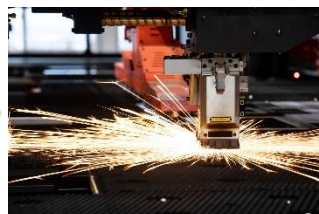
03 材料切断 自動収納庫付き最新鋭ファイバーレーザー加工機にて材料切断
