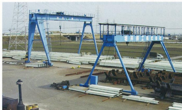
橋形クレーン
