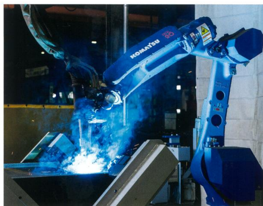
溶接ロボット
