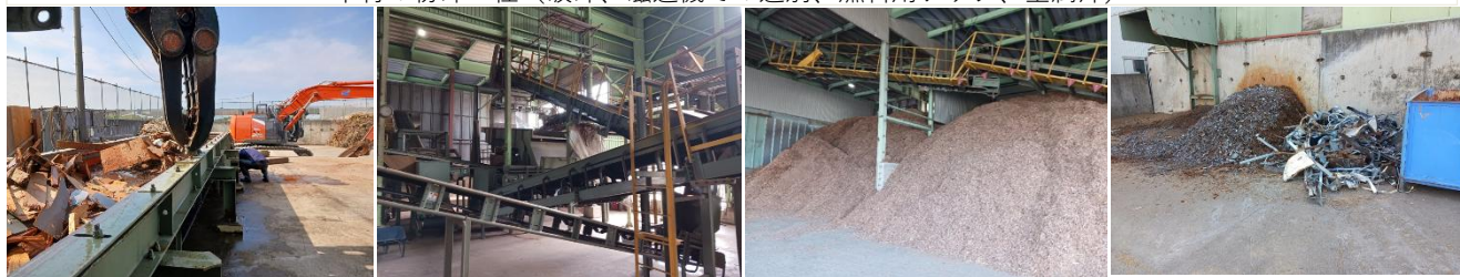
木材の粉碎工程（破碎、磁選機での選別、燃料用チップ、金属片）
