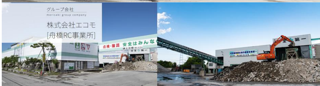
立山 RC 事業所、舟橋 RC 事業所では、解体現場で発生したコンクリートくず・がれき類の再生処理を実施
