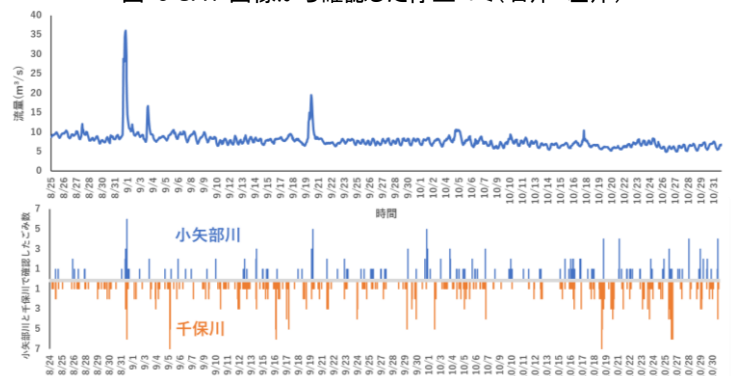
図-4 上)千保川の時間流量, 下)浮遊ゴミ確認数(小矢部川・千保川)
