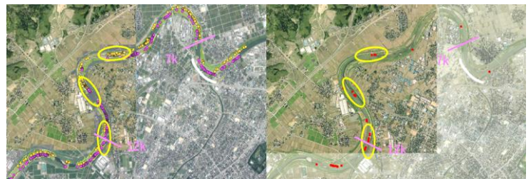
図-5 粒子停止箇所の比較, 左)実績, 右)出水時の計算結果
