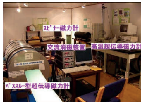
図 3 : 残留磁化用 (パルス型) 超伝導磁力計と磁気シールド室内の各種装置。
